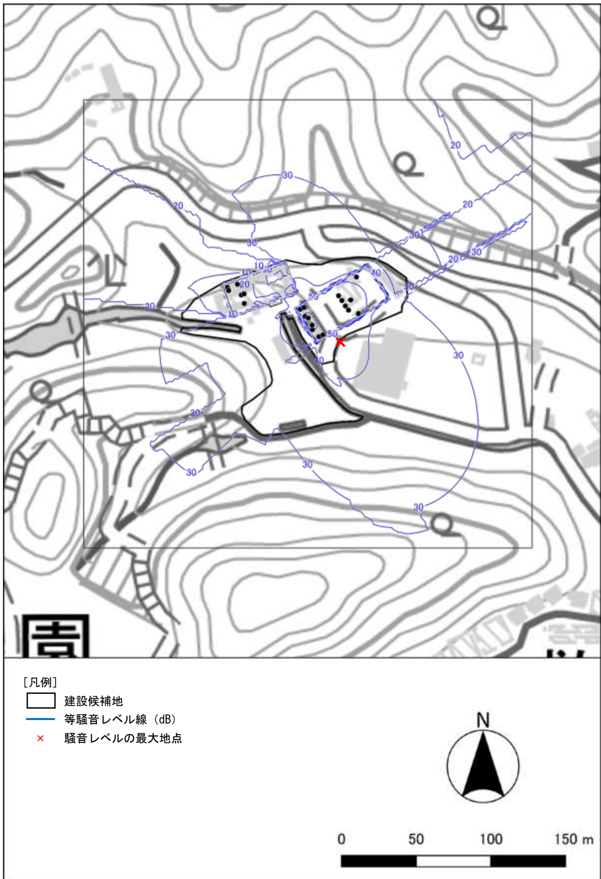
図 4-2-3 寄与騒音レベルの分布状況（粗大ごみ破碎機及び資源化施設が休止）
