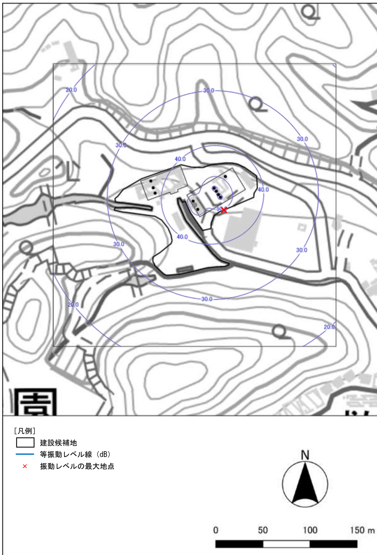
図 4-3-2 寄与振動レベルの分布状況（粗大ゴミ破碎機及び資源化施設が休止）
